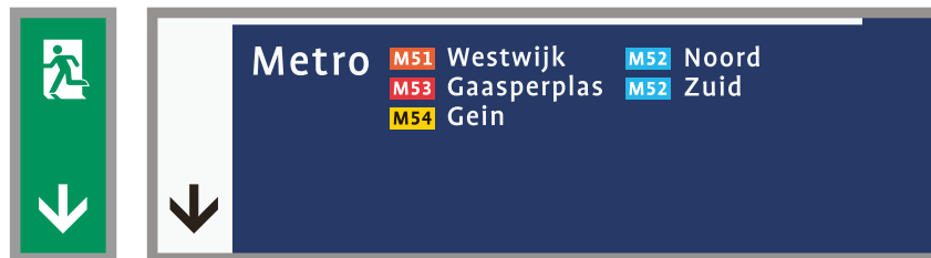
3. De uitzondering - Wanneer een verwijsbord is gekoppeld met een vluchtbord, staan de pijlen in dezelfde richting op dezelfde hoogte.
