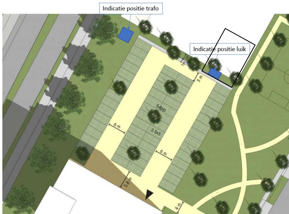
Figuur 14 - Beoogde locatie technische ruimte (zwart) onder het IKC+ met bijbehorende luiken op het terrein van IKC+
