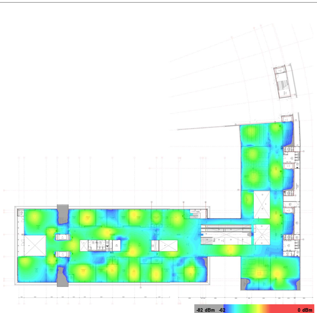
Figuur 12 – Coverage en Signaalsterkte, 03 - 1e verdieping
