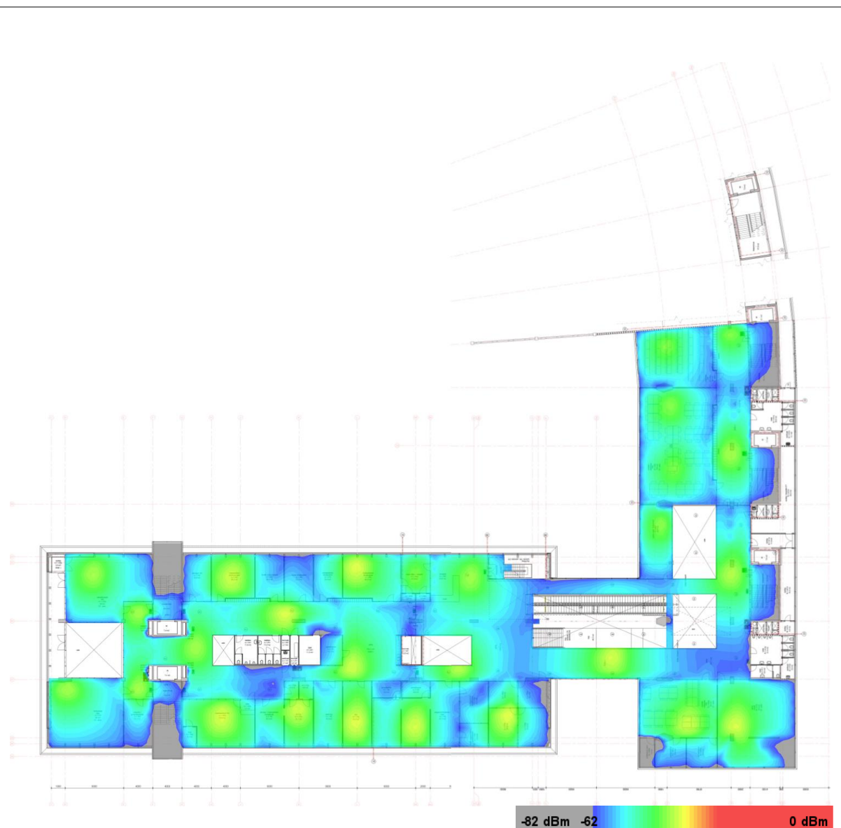
Figuur 67 – Coverage en Signaalsterkte, 03 - 1e verdieping
