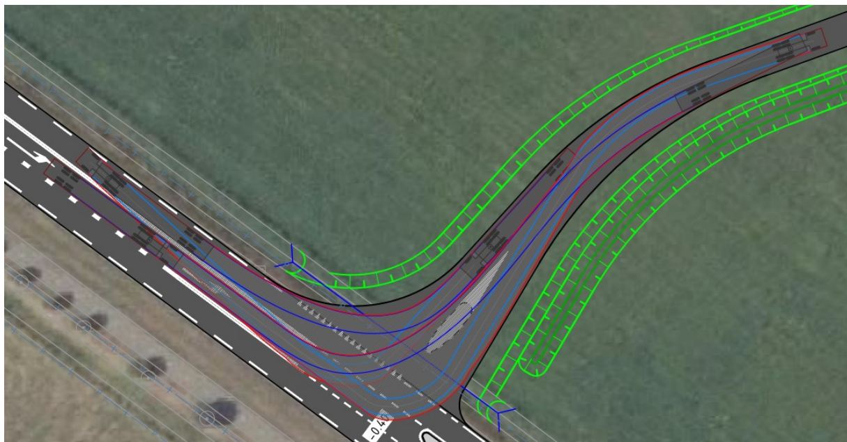
Figuur 15 – Rijcurve dieplader 22 meter lengte
