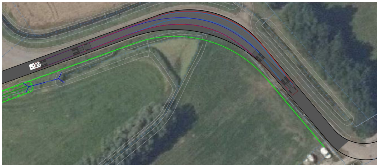
Figuur 19 – De bocht is ruim voldoende voor een dieplader van 22 meter
