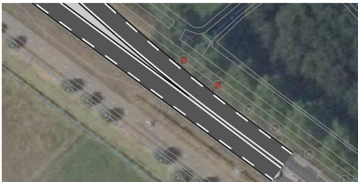
Figuur 16 – Positie twee bomen ten opzichte van de rijbaan: mogelijk te dicht bij de rand van het asfalt?
