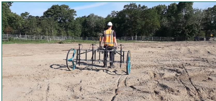
Figuur 2: Non-realtime oppervlakedetectie met de Vallon VXV4.
