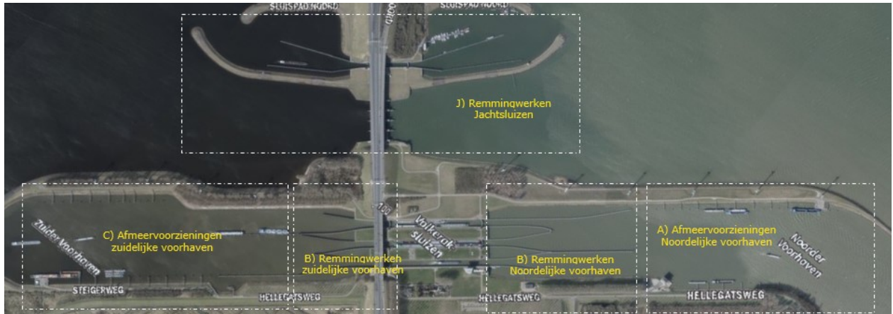
Figuur1: subsystemen van de afmeervoorzieningen en remmingwerken Volkeraksluizen
