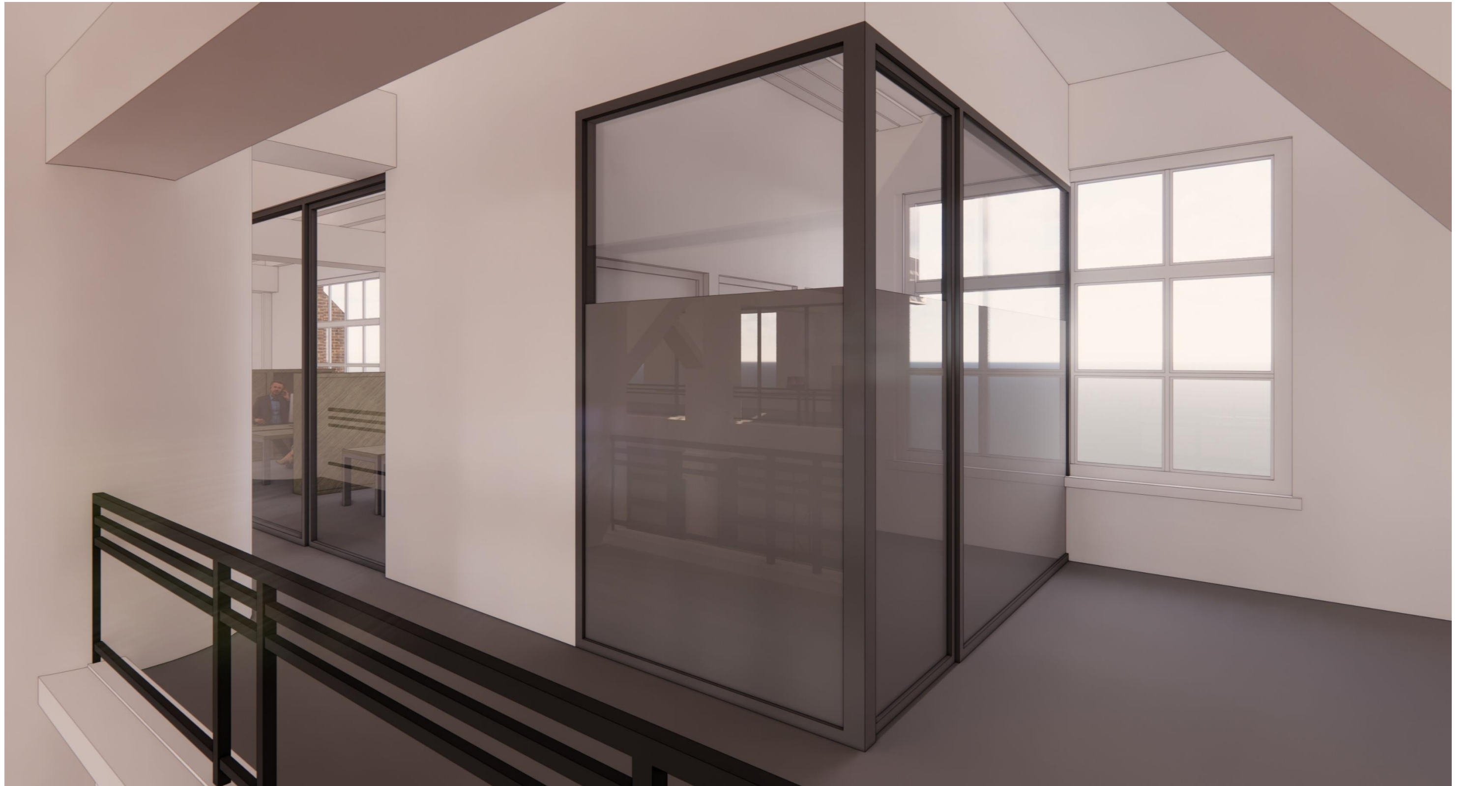
Nieuwe puinen ten behoeve van de nieuwe toiletten op de galerij van de eerste verdieping (ruimte 1.07)
