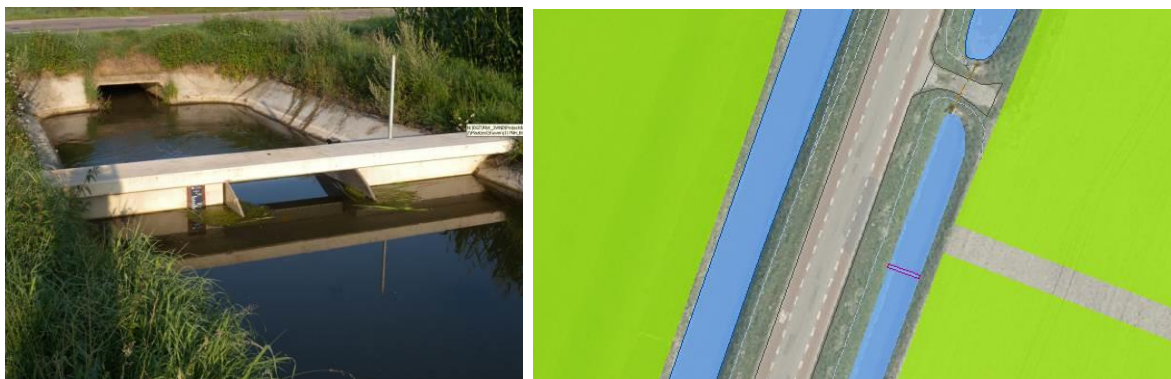
Figuur 3.14 Karteervoorbeeld van een stuw
