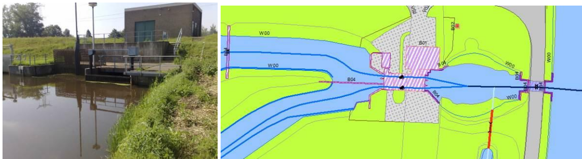
Figuur 3.13 Karteervoorbeeld van een gemaal
