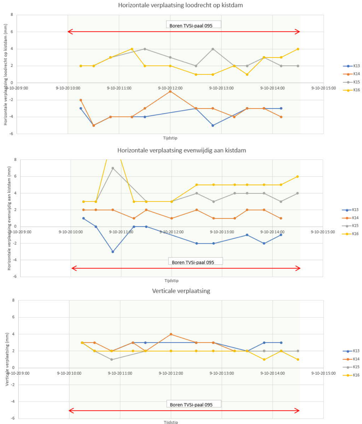
Figuur 27: Resultaten geodetische metingen tgv paalinstallatie 095
