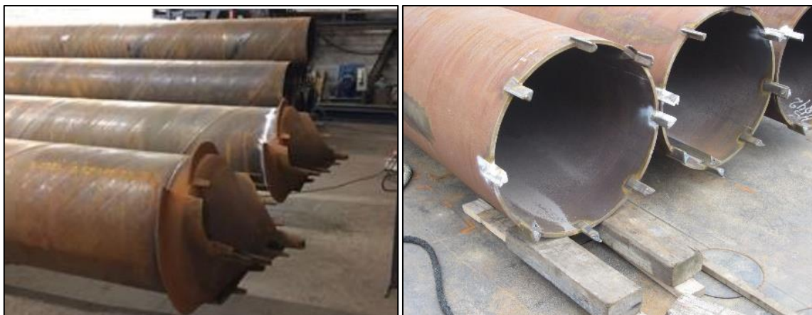
Figuur 25 – Onderzijde TVSI-paal (links) en onderzijde geschroefde open stalen buispaal (rechts)
