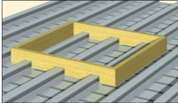
Figuur 66 - Voorbeeld randbekisting op dakplaten
