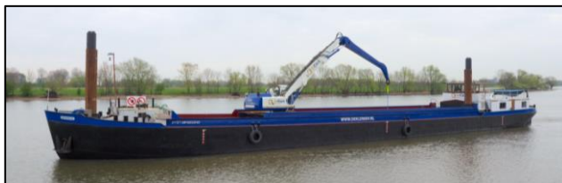
Figuur 76 - Voorbeeld kraanschip 420 afmeting 57,0x 7,27 en ponton 500 ton afmeting ca 40,0 x 8,85
