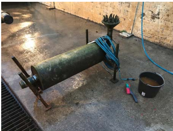
Figuur 8: Pomp Burgemeester van Amersfoordtlaan voor en na de reinigingswerkzaamheden.
