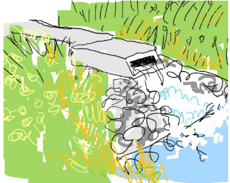
Instroom regenwater in een wadi: betongoot met een erosiebed van keien
