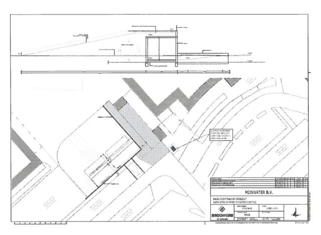
Een van de versies van het voorlopig voorontwerp van de energiecentrale met daarop een locatievoorstel voor de nieuwe transformatorbehuizing.
