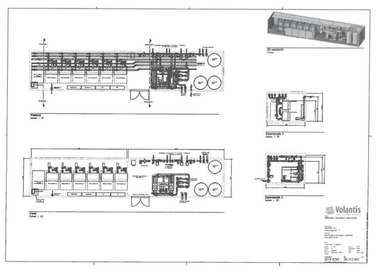
Indicatieve tekening van de opstelling van de diverse systeemcomponenten in (het ontwerp van) de technische ruimte van de energiecentrale ten behoeve van Otterveurdt en In de Biessen.
