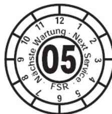
Figuur 5: Keurmerk (in het centrum staat het jaar, de inkeping in de rand geeft de maand aan waarin de keuring moet plaatsvinden).
