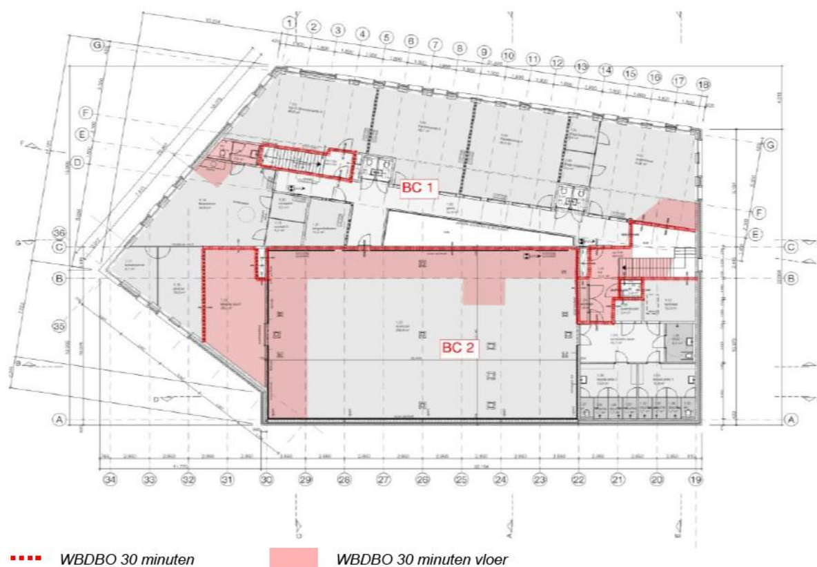
Figuur 2 Brandcompartimentering / WBDBO-eisen verdieping
