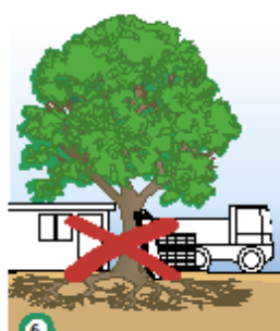
6 Plaats geen bouwmaterialen of bouwmakten en parkeer geen voertuigen onder de kruin van de boom. De grond raakt hierdoor verdicht waardoor boomwortels afsterven.
