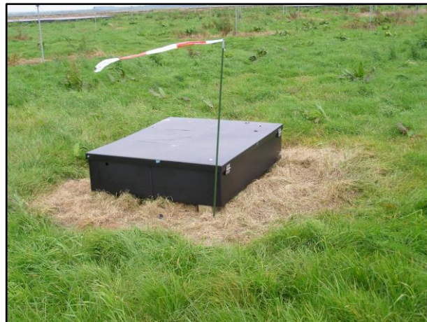
TU Nijmegen deeltjes detector (Op superterp) (1,2x1,2 meter)
