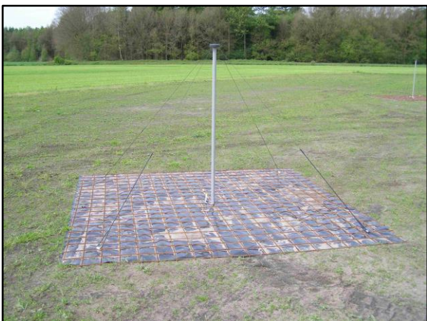
LOFAR Low Band Antenne (LBA) 3x3 meter
