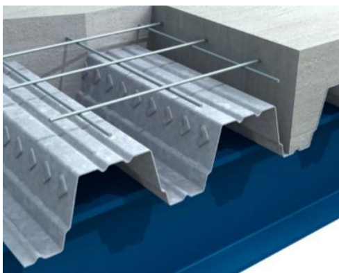
Staalplaatbetonvloer op stalen liggers.
