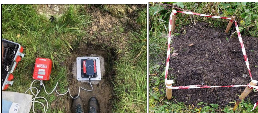
Figuur 3.2: Voorbeeld meetopstelling meetpunt ZT46 op maaiveld (links) en ZT45 ingegraven (rechts)
