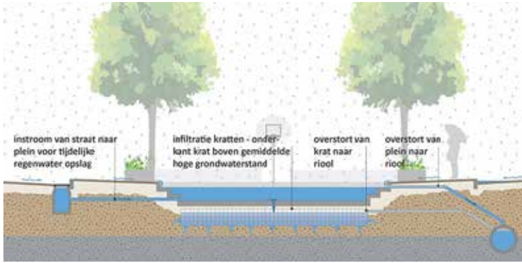
Schematische tekening tijdelijke waterbuffer waterplein
