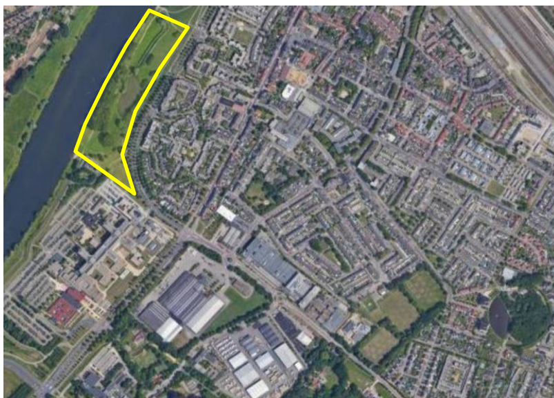
Figuur 2.5 | Potentieel zoekgebied voor TEO-systeem. In het potentiële zoekgebied moet ruimte zijn voor een onttrekkings-, lozingspunt en TEO technische ruimte. Rekening houdend met het doorstroomdebiet kunnen onttrekking en lozing dicht na elkaar plaatsvinden zonder risico op thermische interferentie.
