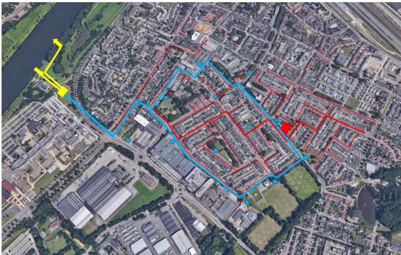
Figuur 2.8 | Schetsontwerp collectieve WKO en TEO met een 70/40 °C warmtenet. De figuur is slechts een voorbeeld van het systeem (haalbaarheidsniveau). In de engineeringsfase wordt nadrukkelijk naar inpassing van de verschillende onderdelen gekeken. De componenten zijn niet op schaal.
