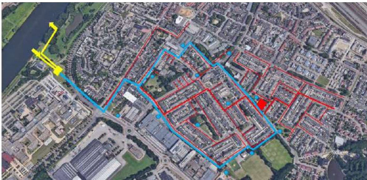
Figuur 1: Schetsontwerp collectieve WKO en TEO met een 70/40 °C warmtenet. De figuur is slechts een voorbeeld van het systeem (haalbaarheidsniveau). In de engineeringfase wordt nadrukkelijk naar inpassing van de verschillende onderdelen gekeken. De componenten zijn niet op schaal.
