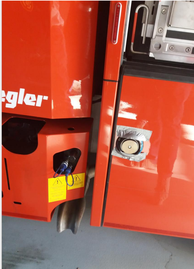
Mercedes Artego Compact en Basis – uitlaat, luchtaansluiting en stroom aansluiting.
