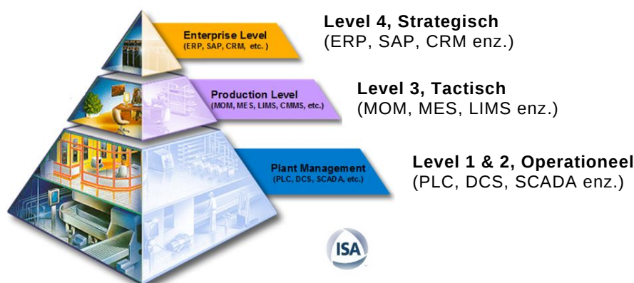
Figuur 1: Automatiseringshiërarchie volgens ISA-95 standaard
