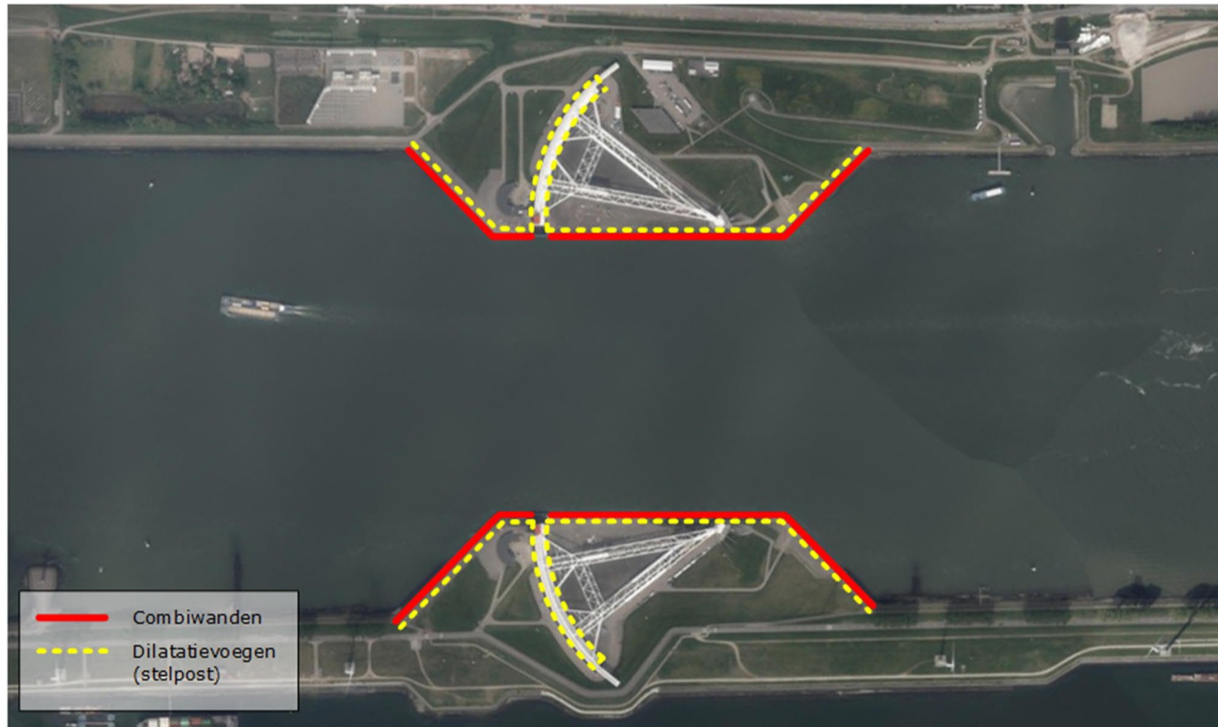
Figuur 1: Situatie combiwanden en dilatatievoegen Maeslantkering
