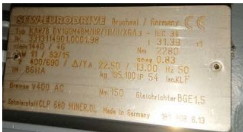
Figuur 4: Type plaat motorreductor spantrek
