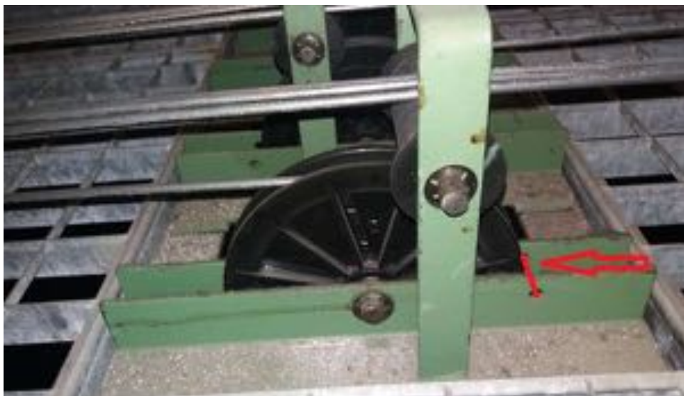
Figuur 14: Dropwiel zonder afloopbeveiliging
