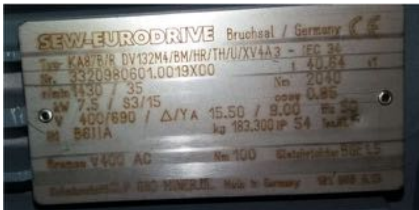
Figuur 3 Type plaat motorreductor decortrek
