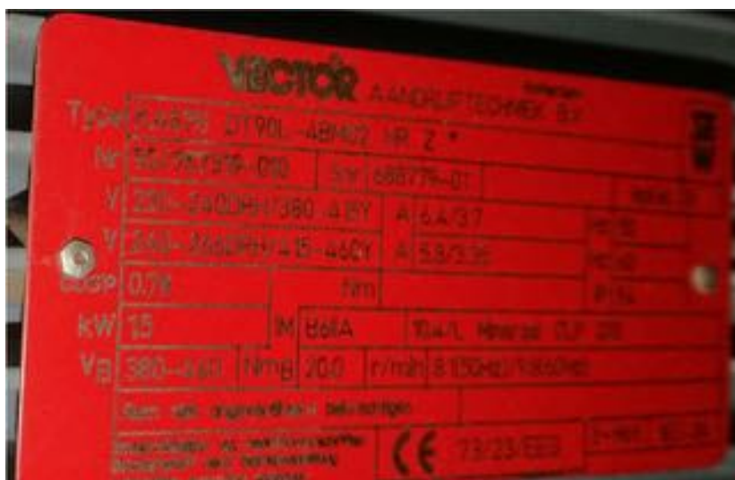
Figuur 5: Type plaat motorreductor zijtrek
