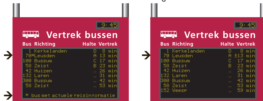
Afbeelding B5.4 Twee alternatieven om bussen met een status 'Unknown' of 'Known' te onderscheiden; Plaatsen van een '*' achter het lijnnummer (links) of plaatsen van '±' voor de minuten (rechts).
