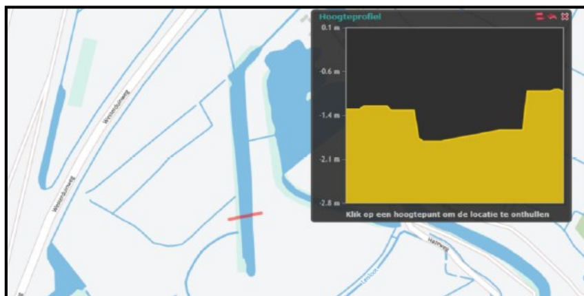
hoogtes dwarsdoorsnede Tankval
