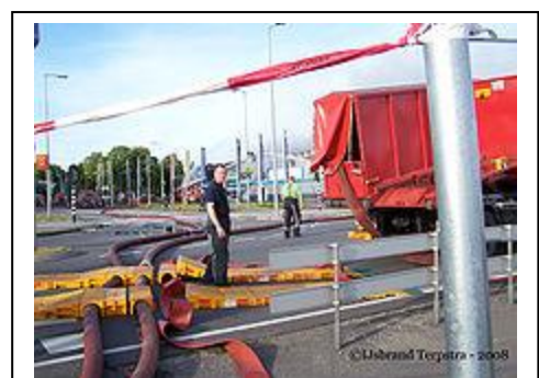
Het watertransportstelsel WTS-1000 bij een zeer grote brand in Amsterdam. Twee slangen liggen al op de grond, de derde wordt uitgelegd vanuit de vrachtwagen. Alle slangen lopen naar een eigen pomp die water verpompt naar alle blusvoertuigen d.m.v. de slangen.
