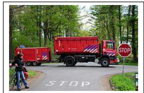
Een haakarmbak met een WTS-1000. Links op de foto de pomp (achter het zeil). Rechts achter, onder het puntdakje de 1000 meter slang. De kast rechtsvoor biedt ruimte aan gereedschap en twee slangenbruggen
