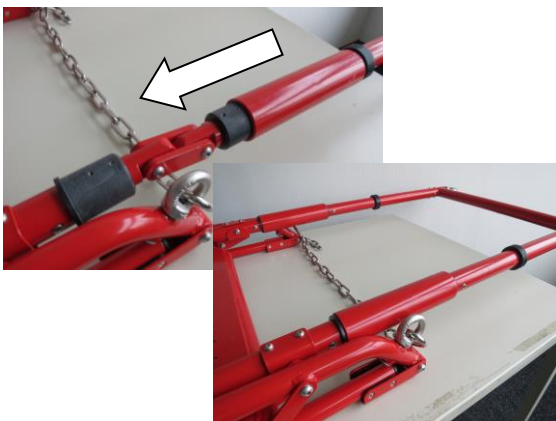
3. Vergrendelen door koker over scharnierpunt te schuiven.
