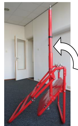
4. Trek stoel omhoog aan de beugel met hijsogen, zodat stoel rechtop staat.
