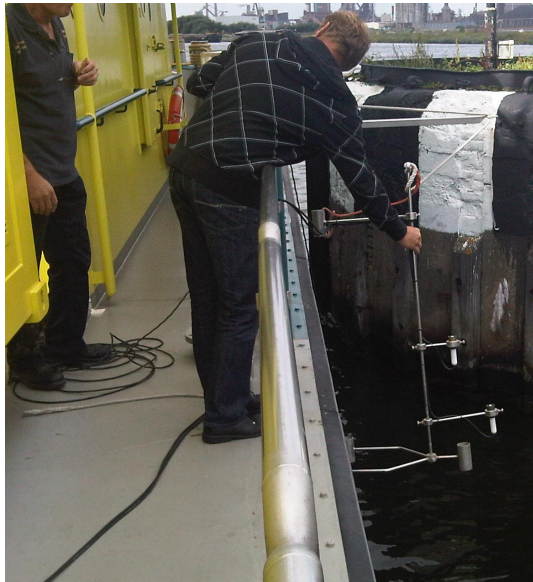
Figuur 12: Toepassing H Handmeting lichtintensiteit PAR (links voor zoet en rechts voor zout)
