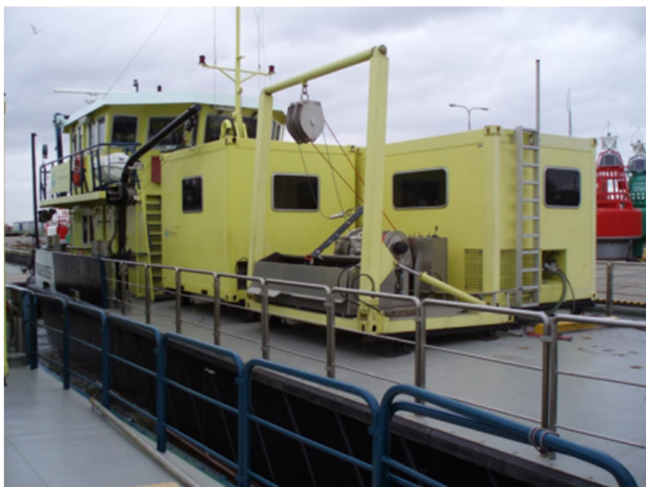
IJsselmeergebied: Ms Zuiderzee voorkant 20 ft MMC en centrifugecontainer (treklier niet meer nodig, meetvis nu in david). Voor IJsselmeergebied wordt nu de ms IJsselmeer of de ms Zuiderzee gebruikt.
