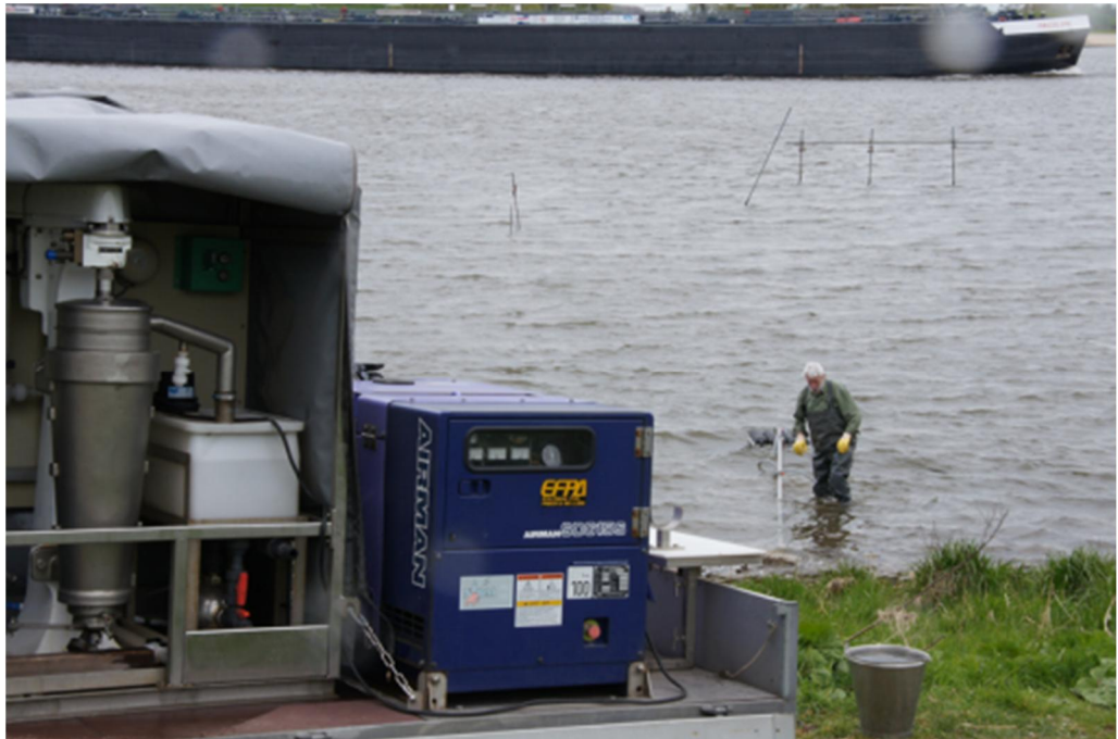
Voorbeeld aanhangwagen met centrifuge en uitzetten aanvoer water in rivier
