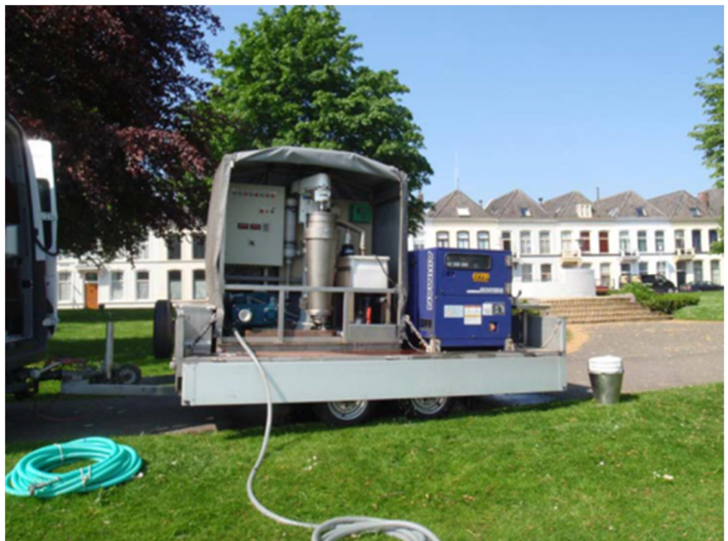
Voorbeeld aanhangwagen met centrifuge, bemonstering langs rivieren
