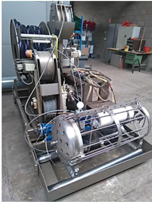
Zeeuwse getijdenwateren: trekliër met meetvis
