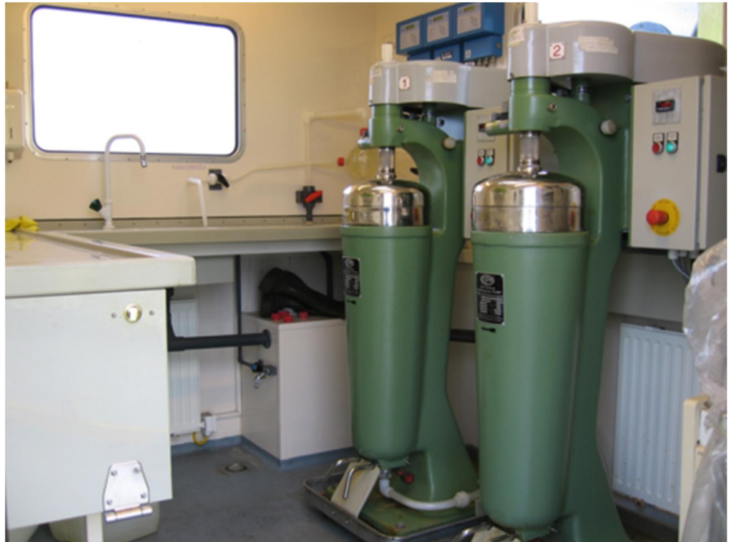
Voorbeeld inrichting centrifugecontainer met twee centrifuges, voor bemonstering met vaartuig.
